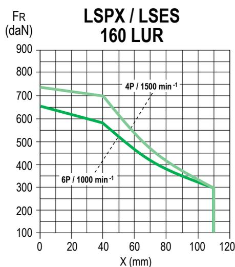
**SPECIAL FITTING ARRANGEMENT (DRIVE-END ROLLER BEARINGS)**
