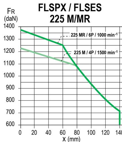
**SPECIAL FITTING ARRANGEMENT (DRIVE-END ROLLER BEARINGS)**
